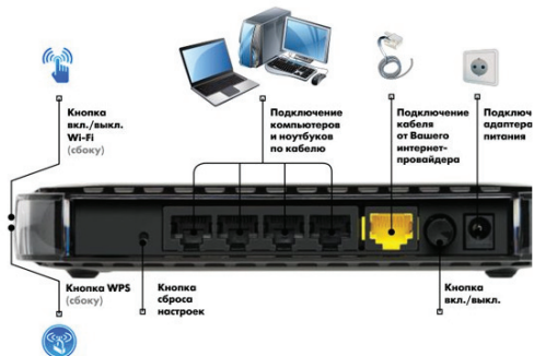
Рис. 2. Внешний вид задней панели маршрутизатора Netgear WNR1000 и схема подключения устройств
